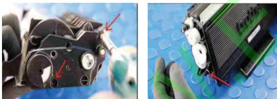
Avant de vous occuper du ressort, enlevez l'engrenage se situant dans le capot, remplacez le ressort puis remettez l'engrenage par dessus. Il ne vous restera plus qu'à remettre le capot sur le côté et de revisser le tout.
