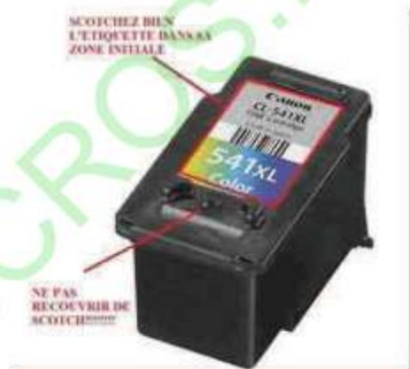
Faites une petite vérification pour voir si l'encre ne coule pas de la tête d'impression (en tenant celle-ci en l'air) et si c'est le cas n'hésitez pas à tremper la tête plusieurs minutes dans une coupelle de solvant.
