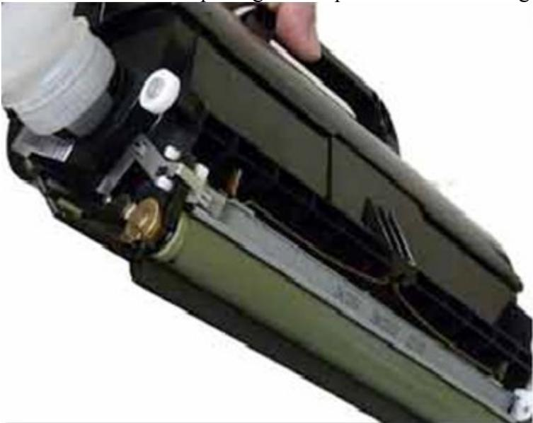
Remplacez ensuite le réservoir sur le socle de la cartouche en faisant en sorte que le tout soit bien clipsé. Remplacez également les ressorts.
