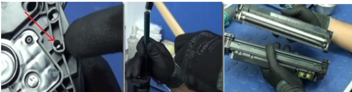
Dévissez ensuite le capot se trouvant sur le côté de la cartouche afin d'avoir accès au bouchon de remplissage. Otez ensuite ce dernier, videz les restes de toner avant de recharger votre cartouche avec la quantité de produit nécessaire.
