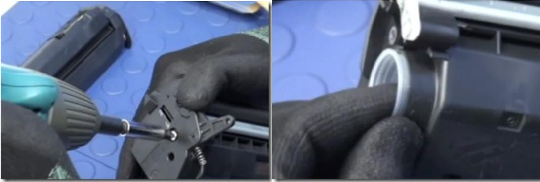
Remplacez le bouchon de remplissage avant de revisser le capot et de remonter la cartouche. Remettez les deux parties de la cartouche ensemble avant de remettre les broches dans leur trou respectif.
