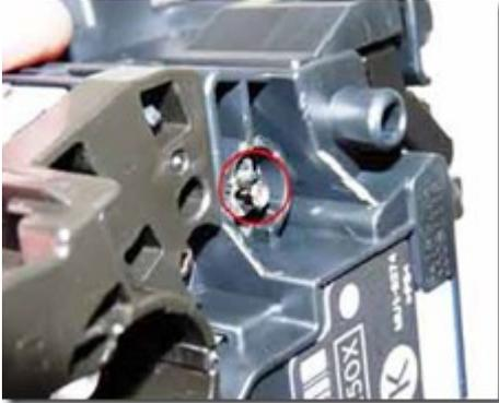
Pressez ensuite le mécanisme de blocage en plastique du côté aux engrenages. Puis, sur le côté opposé, soulevez la chambre à déchets jusqu'à séparer les deux parties de la cartouche.
