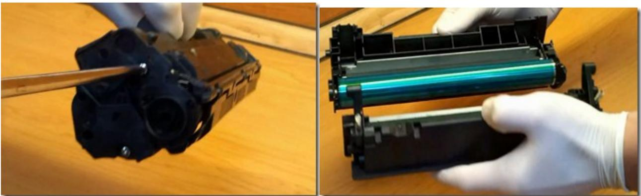
Dévissez ensuite le capot se trouvant sur le côté de la chambre de remplissage et mettez le de côté. Enlevez ensuite le rouleau de développement sans oublier les anneaux et engrenages s'y trouvant. Vous pourrez ensuite dévisser la racle et la mettre de côté.
