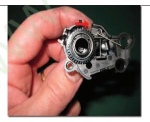
Allez du côté du capot pour remettre le levier métallique en place. N'hésitez pas pour cela à enlever le support en plastique ( le levier devra être placé comme sur la photo ci-contre)
