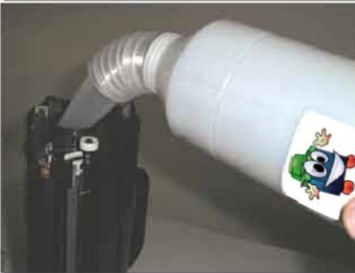
Une fois le remplissage effectué remplacez le bouchon de remplissage avant de remettre la roue
