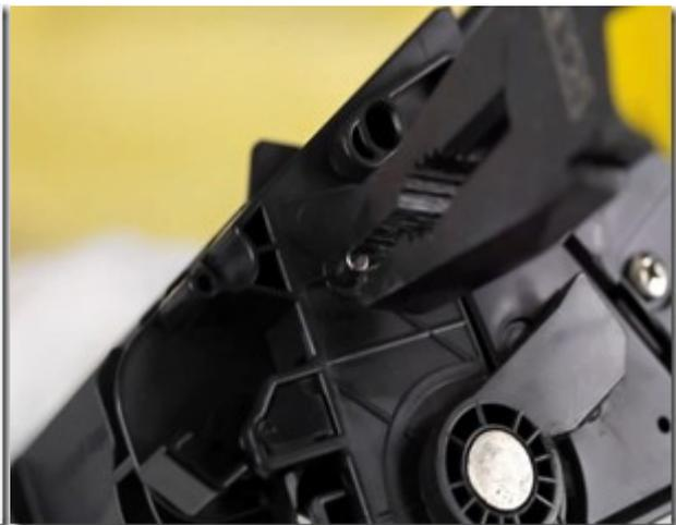
Séparez ensuite la cartouche en deux et mettez le tambour de côté. Dévissez ensuite le capot se trouvant sur le côté de la remplissage avant de le mettre de côté.
